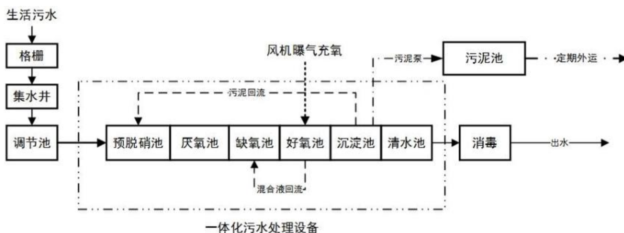
图 2.1-4 生活污水处理工艺流程图
