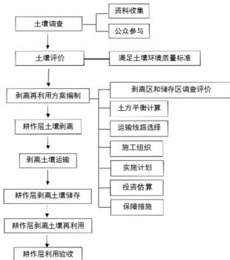
图5-1 土壤剥离利用技术流程图
